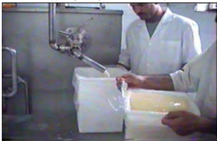
خروج امولسیون جامد از مبدل ابداعی طرح در کارخانه پنیر مینو دشت
